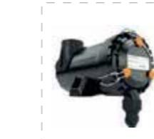
**Hava Filtresi :** MAN/HUMMEL marka hava emi̇ş filtreleri ile uzun süreli kullanım ve daha düşük direnç özelli̇ğine sahip olmaktadır. 50 mbar tikanma sensö̇ri vasıtasiyla filtrenin tikanma durumu ekrandan izlenebilir. Tikali bir filtre ile çalışan kompresörde (100mbar) hava üretiminde %10 verimsizlik olmaktadır.
