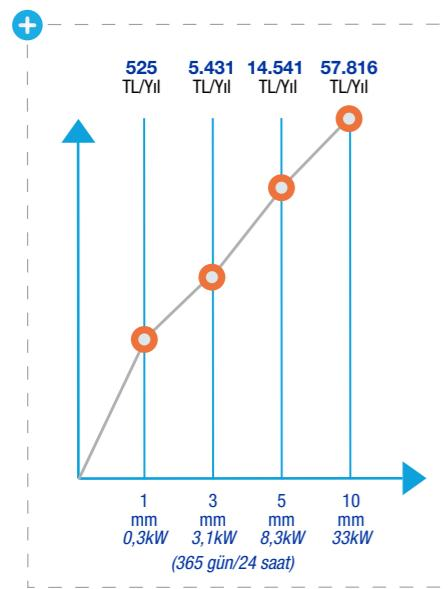
Sistemdeki hava kaçakları enerji tasarrufu için önemli bir fırsattır. Hava kaçakları genellikle emniyet valfleri, boru ve hortum bağlantı yerleri, kesici valfleri, pnömatik aletlerde meydana gelir. Kaçak tespiti için aşağıdaki yöntemlerden biri uygulanabilir;
