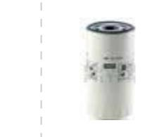
**Yağ Filtresi :** LUPAMAT marka yağ filtreleri ile uzun süreli kullanım ve etkin partikül filtrasyonu sağlanmaktadır. Yağın ömrünü uzatır. Filrenin tıkanma durumunu algılayan sensör vasıtıyla ekrandan tıkanma durumu izlenebilir. Tikali bir yağ滤resi ile çalışan kompresörde yeterli yağlama olmadığından dolayı sıcaklık yükselecek ve vida rotorları zarar görebilecektir. Kullandığımız filtrelerde standart özellik olarak bypass özelliği bulunmaktadır.
